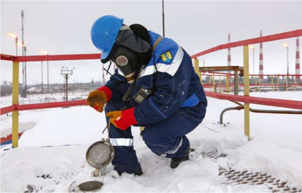
Ведется ручной замер уровня продукта в резервуаре
