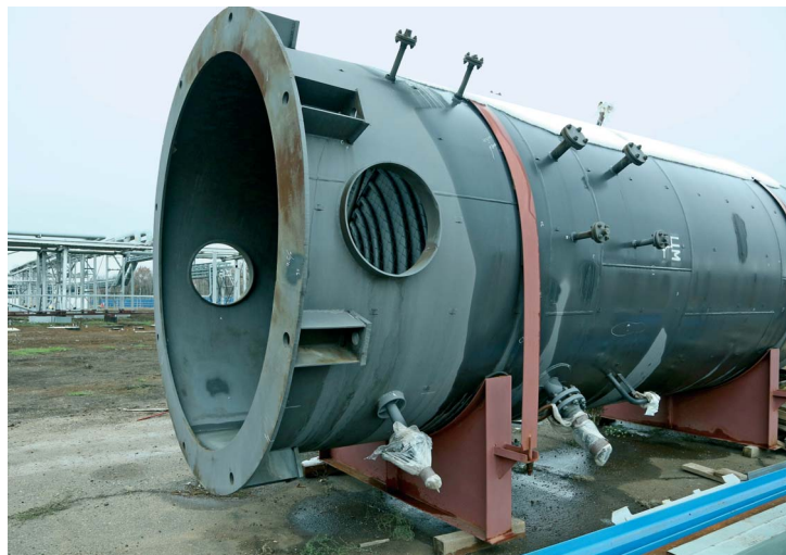
На УКПГ-2 будет установлен новый факельный сепаратор
