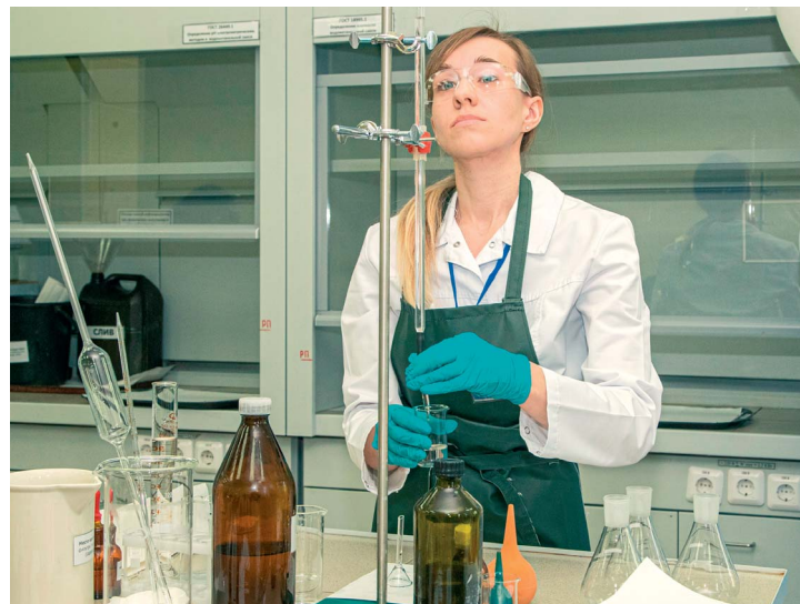
Ирина Бузулукская определяет массовую концентрацию хлоридов в пробе воды
