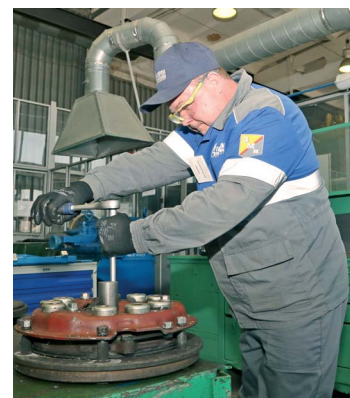
Ремонт сцепления проводит Иван Строкин
