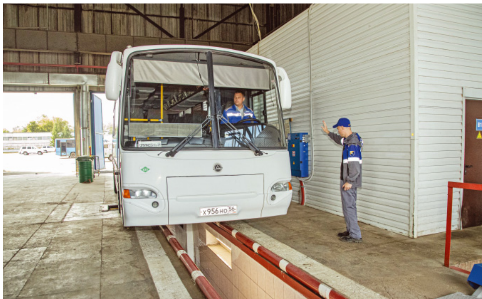
Диагностическая линия технического осмотра в управлении технологического транспорта и специальной техники
