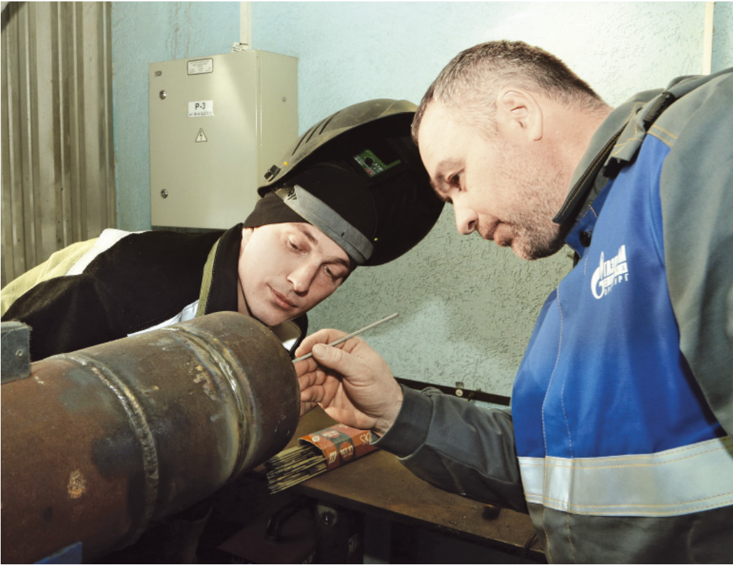
Алексей Бурдин и Максим Осипов проверяют, как выполнена корневая сварка шва
