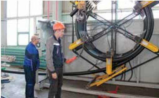
Ведется намотка бухты готовой трубы
